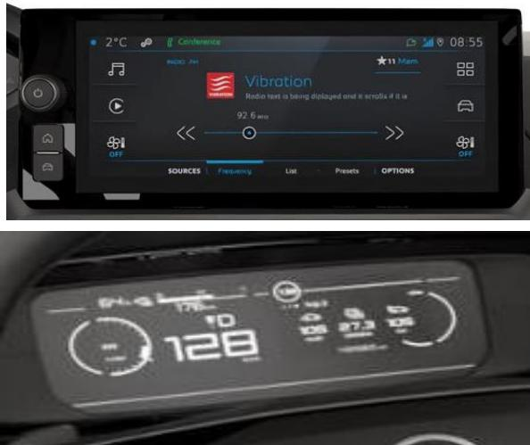
Dispone de sintonizador de radio AM/FM/DAB, Mirror Screen por USB o por WiFi con protocolo Android Auto y CarPlay, Bluetooth, 1 USB-C de datos y 1 USB-C de carga, reconocimiento de voz vía smartphone y es compatible con cámara de visión trasera SD (analógica) y con protocolo BTA4G
